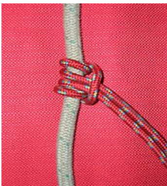
Figura nr.5 Funie auxiliară „Решнур” legat de coardă folosind nodul de fixare „Схватывающий”
